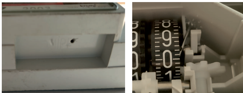
Rys. 4 i 5. Ingerencja poprzez wywiercenie otworu w osłonie liczydła i liczydłe Fig. 4 and 5. Interference by drilling a hole in the index cover and index
