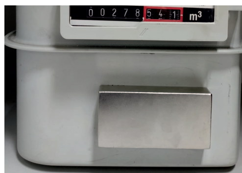
Rys. 6. Ingerencja poprzez przyłożenie magnesu trwałego do obudowy gazomierza Fig. 6. Interference by applying a permanent magnet to the gas meter casing
