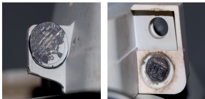
Rys. 1 i 2. Uszkodzenie plombki legalizacyjnej Fig. 1 and 2. Damage to the verification seal
