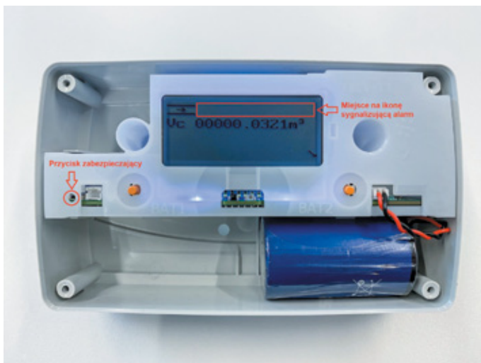
Rys. 4. Liczydło gazomierza iSmart2 produkcji Aparator Metrix S.A. po zdjęciu pokrywy liczydła
