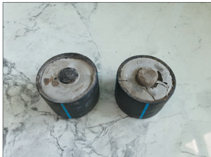
Rysunek 4. Rdzenie skalne zalane zaczynem cementowym po utwardzeniu przez 7 dni (po lewej: przed pomiarem, po prawej: po wykonaniu pomiaru przyczepności na kontakcie cement–skała)
