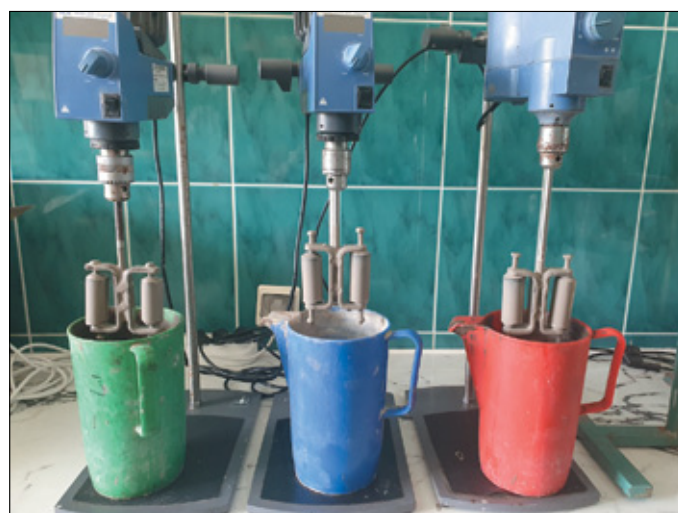
Rysunek 3. Stanowisko do mieszania rdzeni skalnych w poszczególnych cieczach
