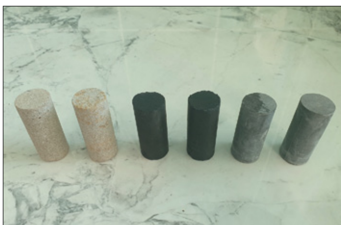
Rysunek 2. Wycięte rdzenie skalne. Od lewej: rdzenie z piaskowca, węgla i mułowca
