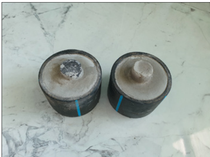
Rysunek 4. Rdzenie skalne zalane zaczynem cementowym po utwardzeniu przez 7 dni (po lewej: przed pomiarem, po prawej: po wykonaniu pomiaru przyczepności na kontakcie cement–skała)
