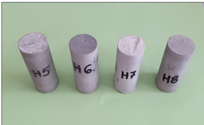
Rysunek 2. Przykładowe próbki (rdzenie) stwardniałych zaczynów cementowych przeznaczonych do badań szczelności względem wodoru
